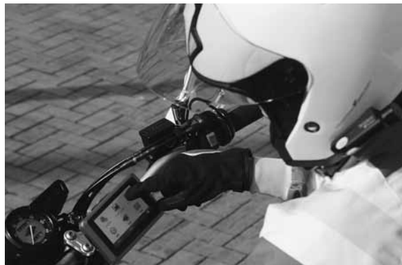
グローブをした状態でも操作性に優れたバイク専用ナビゲーション 写真提供：ヤマハ発動機
