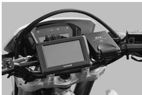
アンテナ一体タイプのバイク用ETC 写真提供：本田技研工業
