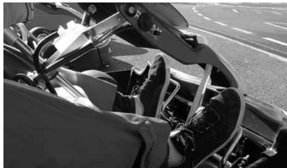
カートには基本、アクセルとブレーキ2つのペダルしかない。
