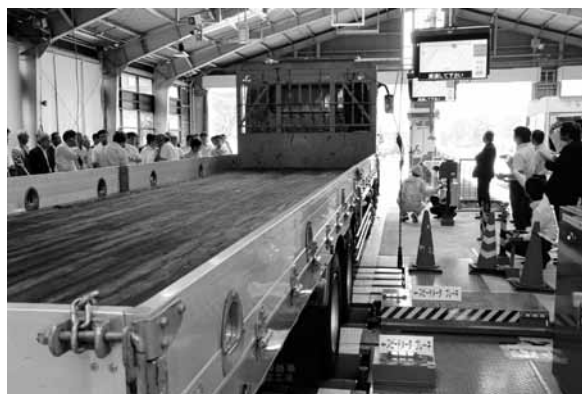
大型マルチテスタを使用した、大型トラックのスピードリミッタ(速度抑制装置)の検査：自動車検査独立行政法人・関東検査部
