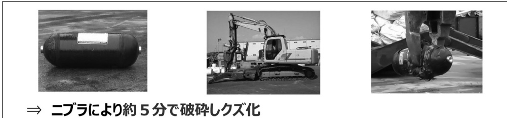
図8●CFRP製水素タンクのクズ化と電気炉による処理試験 (13)
