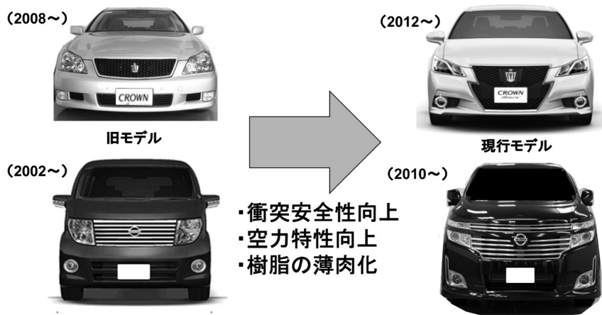
図2●フロントグリル大型化による樹脂の薄肉化の事例 (5)
