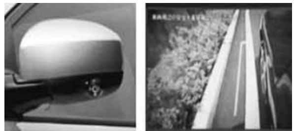
車両左前方の死角を減らし、道路端への幅寄せや縦列駐車などをサポートするサイドブラインドモニター 写真提供：日産自動車
