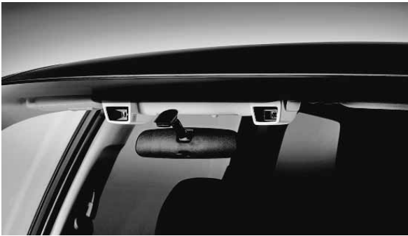
2つの目でヒト・モノ・クルマを見分けるアイサイト 写真提供：富士重工業
