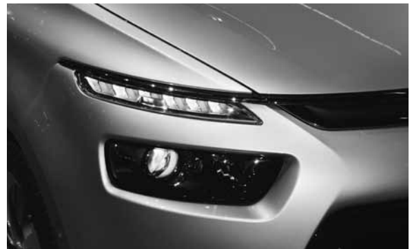
シトロエンの新型C4ピカソ。上段に薄型のデイタイム・ランニング・ランプ (DRL)、下段にヘッドランプを配した2段構成。DRLで個性を表現する代表例のひとつだ。
