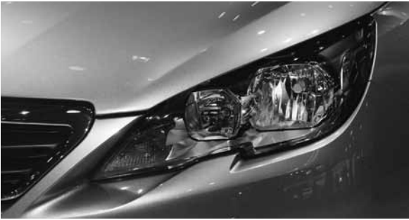
プジョーの新型308はグレードによりヘッドランプが異なる。上級グレードはLEDを採用して小型化。小さくすることで技術の先進性を表現する狙いだ。
