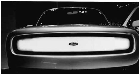
図5●車両のフロント全面にLEDを敷き詰めた フォード021C (1999年東京モーターショー)
