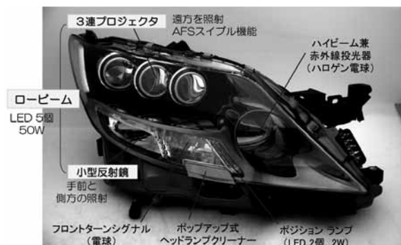
図3b●LS600h LEDヘッドランプの機能
