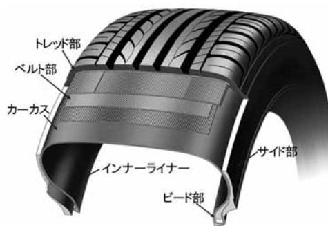
図5●乗用車用タイヤの構造例
