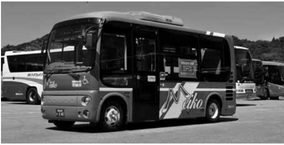
近年の地方バスは中型～小型が主力 病院路線などではバリアフリー対応で日野ポンチョが主力車種に（明光バス）
