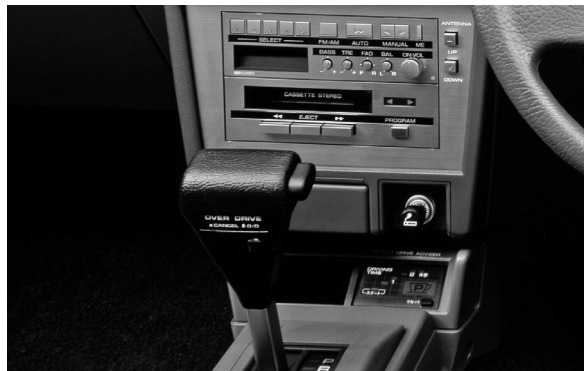
写真7●セーフティドライブアドバイザー （日産ブルーバード 1985年）
