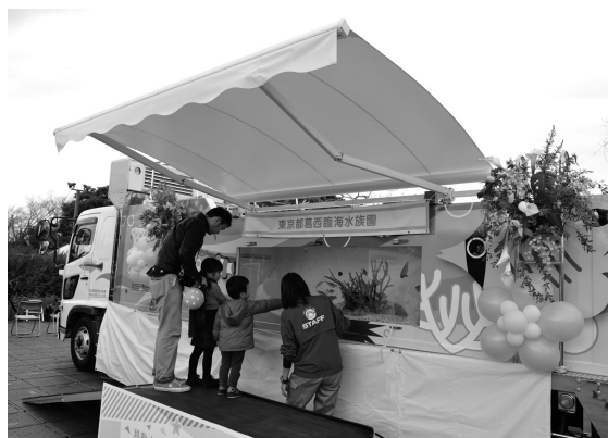
うみくる号は、全長約8m、積載量約4tのトラックをベースに、1.6tの水槽を2基搭載している。車体の両面から、それぞれの水槽を見ることができる。2基の水槽は、それぞれ水温などが異なる環境に設定することができる。そのため、ポンプや水温調節の設備なども搭載している。左下は、実際の展示のようす。右下では、車両の横にスロープと台を設置して、その上に乗って水槽を見てもらっている。
