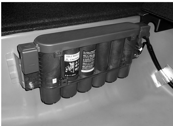
トランク下部に設置されているキャパシタ
