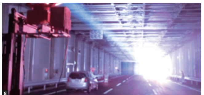
7 様々な雨を再現できる 8 投光機を用いると、強い西日が再現できる
