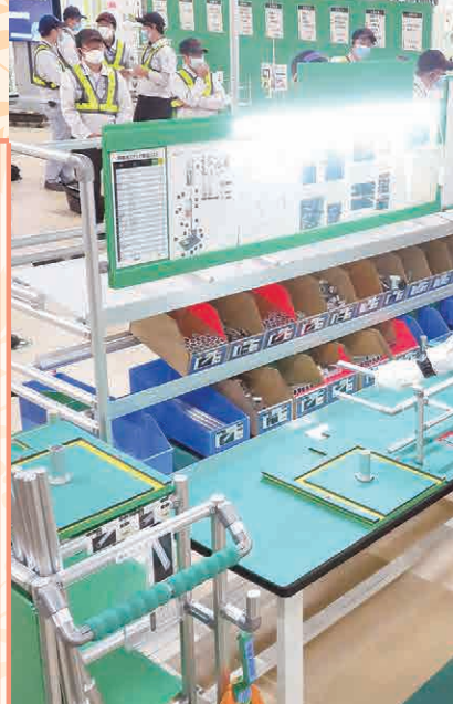
▲使う部品を組み付け場所や順序に合わせて用意し、生産性を向上
