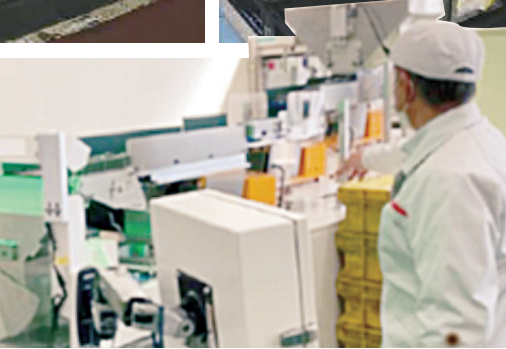
▲チョコ停・調整時間を86%低減した自動計数機
