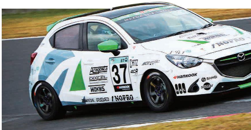
▲ マツダが開発した100%バイオ燃料を使用するディーゼルエンジンのレース車両
