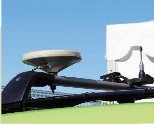
▲ヴァレオの試験車両に装着されていたV2X用アンテナ
