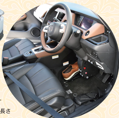
▲ 国内メーカー唯一の足だけで走行できる 「フランツシステム」を搭載した「フィット」
