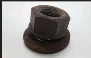
ホイールナットとワッシャーに変形が見られ、ワッシャーがはずれかかっている。
