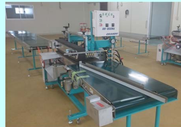
ねぎの洗浄設備
