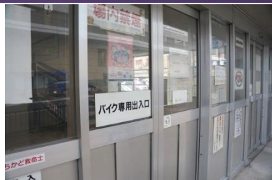
【出入口】入口にある自動販売機でプリペイドカードを購入し、機械に挿入すると入口の扉が開く構造になっている。退出するときは、室内にある読み取り機にカードを挿入すると扉が開く仕組み。なお、時間を超過して駐車した車両には管理人がチェーンロックを施錠し、超過料金を徴収する。
