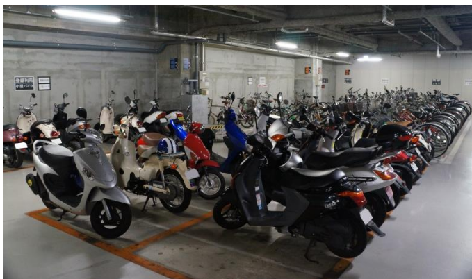
【レイアウト】自転車と二輪車の駐車スペースを分離した。原付枠は（700mm×1700mm）、自動二輪枠は（800mm×2,400mm）。
